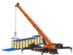
长边立式吊车卸货示意图
