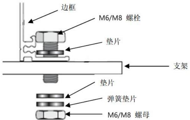
图 2 螺栓安装过程示意图
