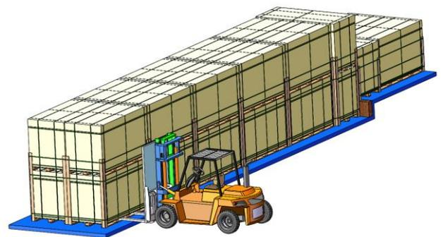
短边立式、U型包装叉车卸货示意图
