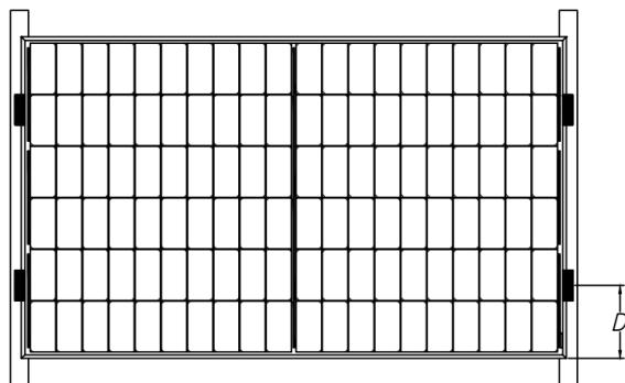
图 5 导轨重合短边框安装
