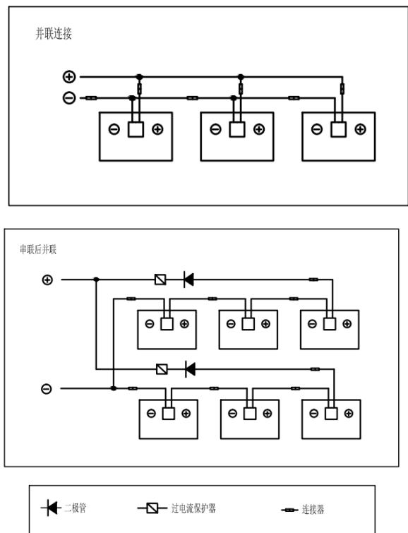
图 11 电联接示意图
