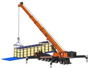
长边立式吊车卸货示意图
