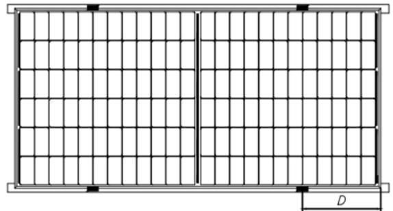
图 3 导轨重合长边框安装
