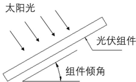
图1 光伏组件安装倾角示意图
