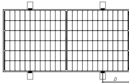
图 4 导轨垂直长边框安装
