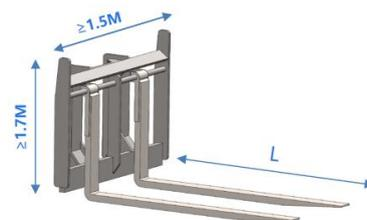
叉车门架：高 $\geq 1.7M$ ，宽 $\geq 1.5M$ ，
