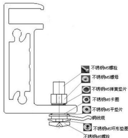
图 12 使用铜线缆将铝边框接地
