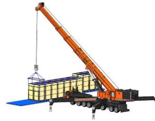
Descarga de paquetes verticales lado largo con grúa
