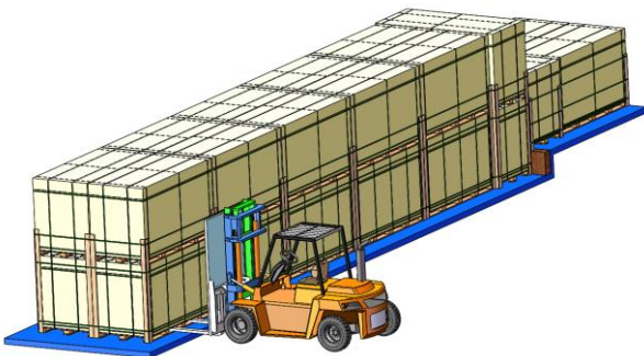
Descarregamento da embalagem vertical pelo lado curto e da embalagem em forma de U com empilhadeira
