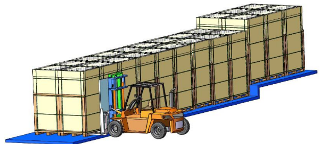
长边立式叉车卸货示意图
