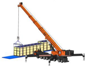
长边立式吊车卸货示意图
